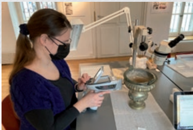
Naima Gutknecht, de la HE-Arc en conservation-restauration à Neuchâtel, en train d'effectuer une spectroscopie de fluorescence X par XRF portable sur l'une des pièces étudiées dans le cadre du projet Interreg MetalPAT.
